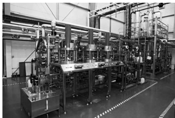
Abbildung 2. Produktions-SMB-Anlage. Wiedergabe mit Genehmigung von R. M. Nicoud (Novasep, Vandœuvre-les-Nancy, Frankreich).
